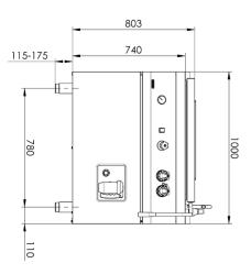
E - přívod napětí 400V WD - přívod vody do duplikátrou W - přívod vody
